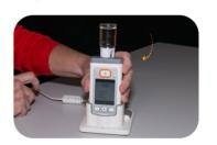
9.Retire el frasco de la bomba con un adaptador de colocación y gire en sentido antihorario.
