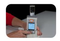
10.Entornille la línea de infusión en la conexión luer del reservorio de la bomba.
