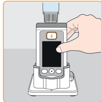
Presione **Sí** para iniciar el proceso de llenado. La unidad bombeará el medicamento del frasco al reservorio.
